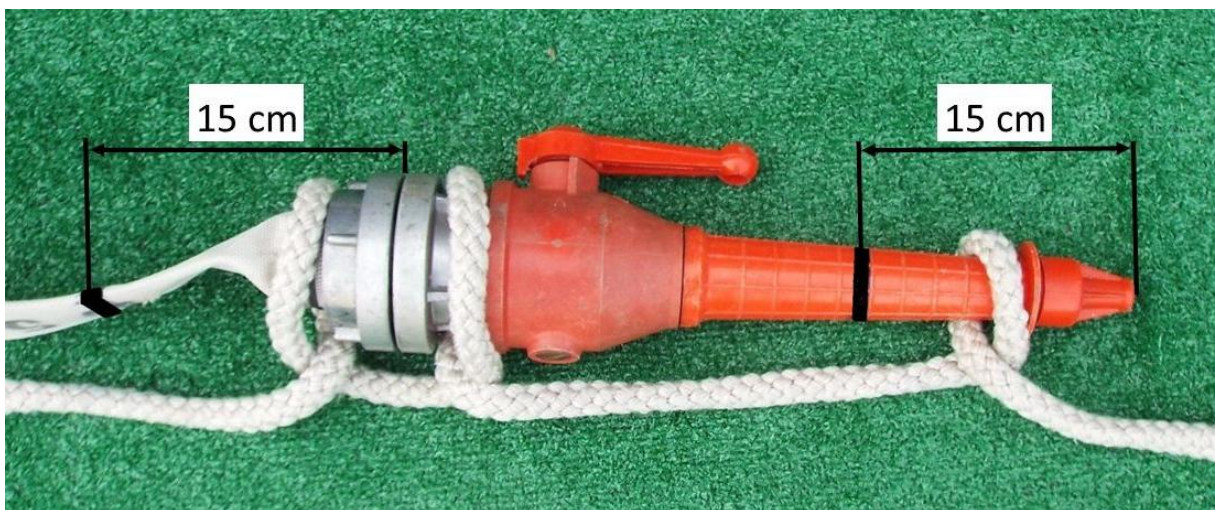
węzeł na prądownicy
